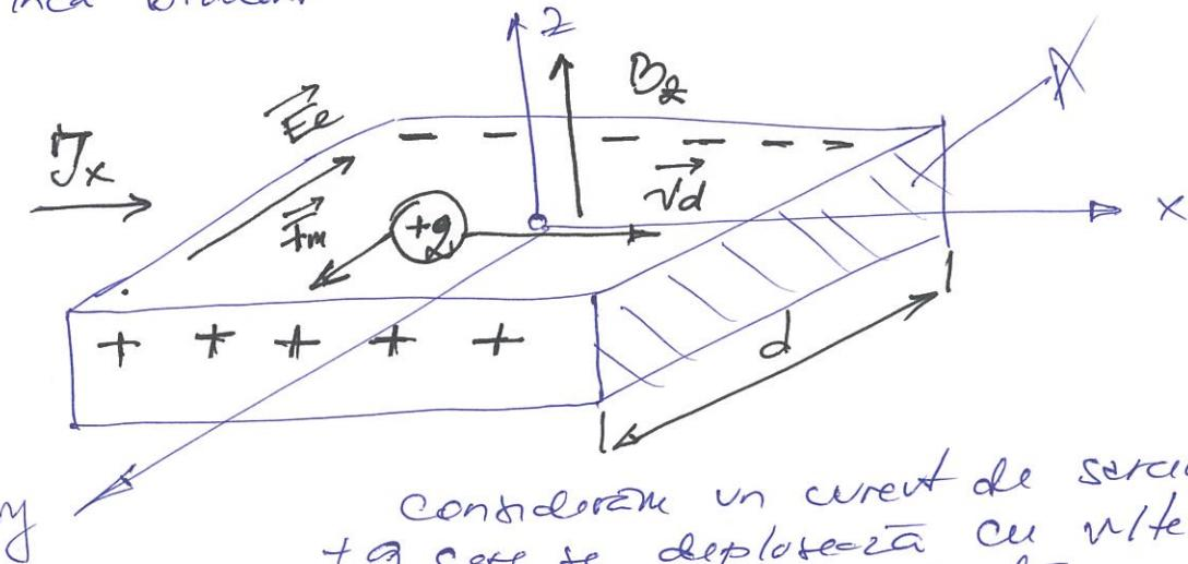
Considerem un curent de sarcină pozitive  $+q$  care se deplasează cu viteză de drift  $v_d$  într-o sondă pe care un camp magnetic  $\vec{B}$  este perpendicular
