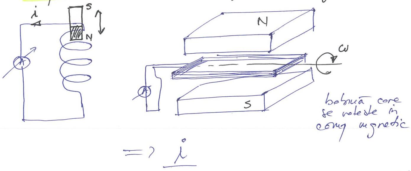
În aceste experimente curentul apare prin (la) variație fluxului magnetic în circuit
