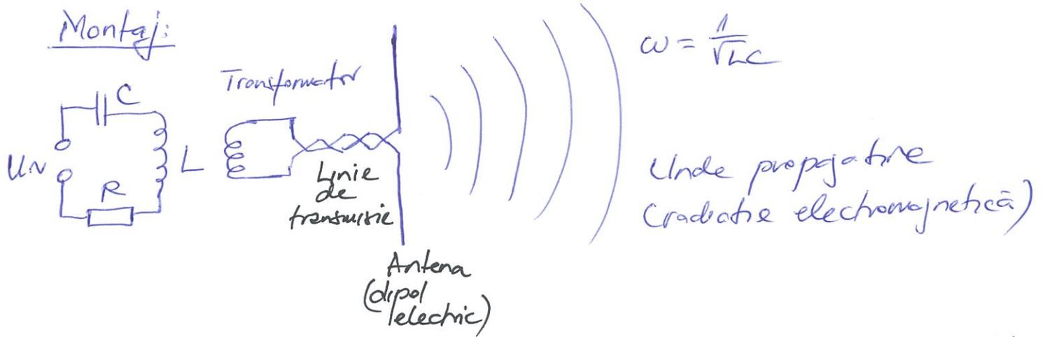
Antena: are rolul unui dipol electric fiind constituită din două elemente metalice conductoare. Curentul electric oscilant din circuitul RLC produce în antenă o mișcare oscilatorie a sarcinilor (electroni) cu frecvența  $\omega = 1/\sqrt{LC} \Rightarrow \vec{E}(t) \rightarrow \vec{B}(t)$  și md.
