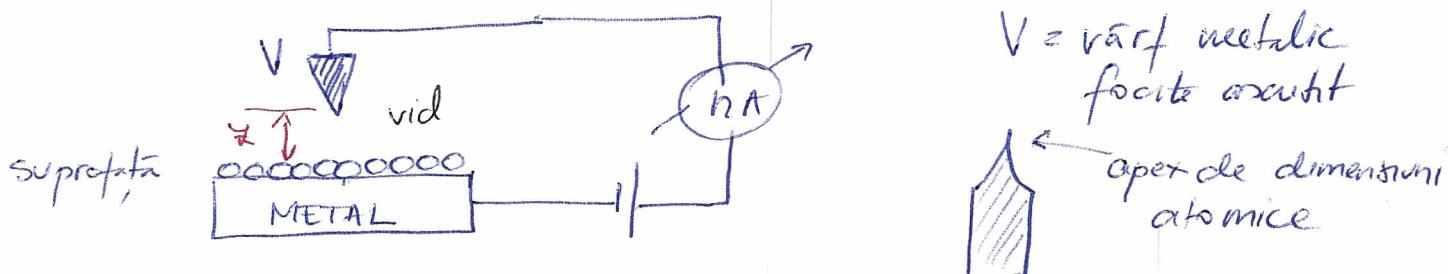
Curentul traversează distanța dintre vârf și suprafață prin efect tunnel. Transmiterea electronilor și deci implicit curentul măsurat depind exponențial de distanța vârf-suprafață.
